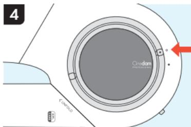
フィルターを元の位置に戻し、吸込口カバーの●印と本体の○印を合わせて挿入します。
