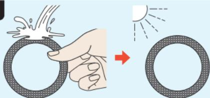
フィルターを取り出し、流水できれいに洗い、十分に乾燥させます。
