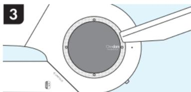
吸込口に付着したごみは、掃除機で吸い取るかピンセットなどで除去してください。
